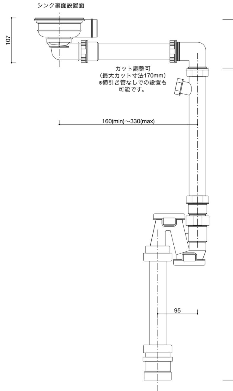
排水金具中心から排水管の最大振り範囲：425mm
